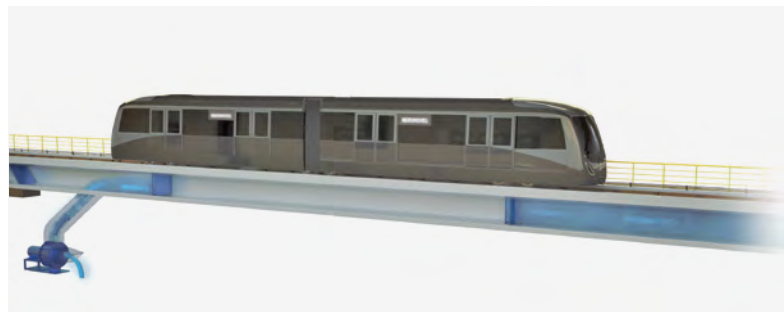
Modelo de funcionamento do sistema de propulsão pneumática.
