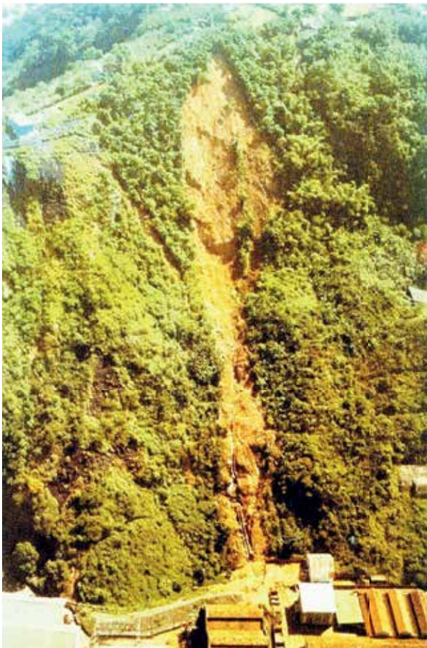
Figura 1 - Escorregamento Translacional Raso (ou Planar) típico. Local: Morros de Santos e São Vicente. Notar a proximidade da “raiz” da crista do espigão e a pouca profundidade dos solos superficiais mobilizados (Foto Arquivo IPT)
