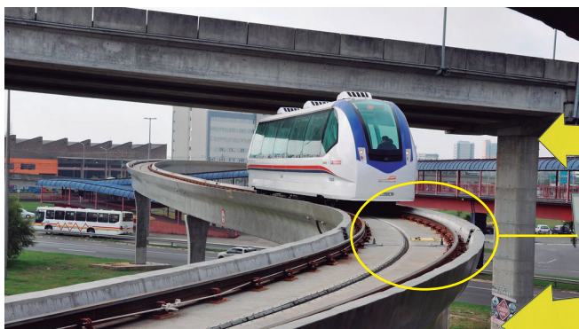
Figura 2 - O sistema de propulsão
